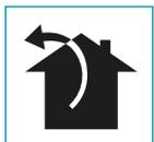
U ovoj verziji plinovi i pare su ispušteni vani kroz ispušnu cijev. Radi toga, izlaz nape mora biti spojen putem cijevi na vanjski izlaz. Izlazna cijev mora imati:
