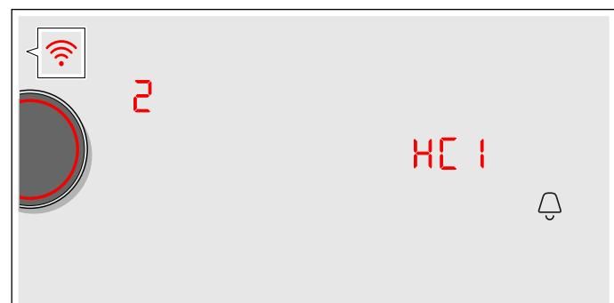
5. Înregistrați un dispozitiv mobil în rețeaua plitei cu SSID „HomeConnect” cu cheia „HomeConnect”.
