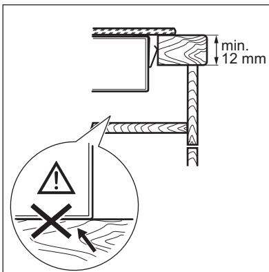
**i** Dacă aparatul este instalat deasupra unui sertar, ventilația plitei poate încălzi articolele depozitate în sertar pe durata procesului de gătire.
