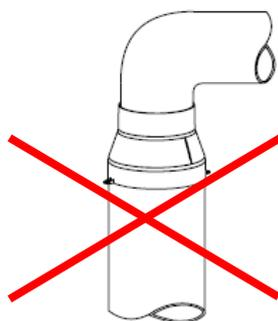
D. Se recomienda usar conductos que tengan una pérdida de carga mínima por fricción, las paredes cuanto más lisas mejor, y en caso de ser conductos flexibles colocarlos bien estirados para que las paredes con espirales queden lo más lisas posible, pues esto mejora el nivel de aspiración y reducen el nivel sonoro.
