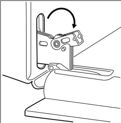
3. Închideți pe jumătate ușa cuptorului până la prima poziție de deschidere. După aceea, ridicați și împingeți și scoateți ușa din locaș.
