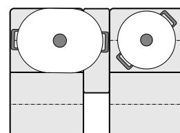
Pentru a aloca zona de gătit FlexPlus poziției de gătit corespunzătoare, ridicați vasul, selectați o treaptă de preparare termică și apoi așezați-l din nou.
